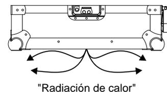
Como se puede ver en el dibujo de arriba la "radiación de calor" que produce el reproductor es evacuada fuera del flightcase, evitando cualquier malfuncionamiento del aparato.
